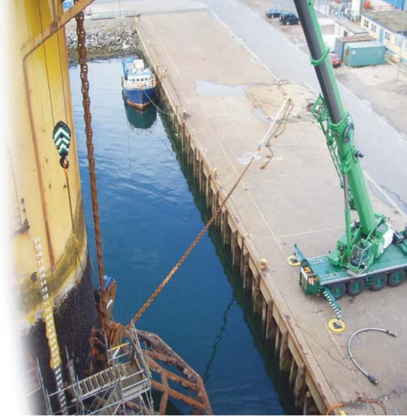
我们的锚机监控系统能够用来监控大部分锚机类型。该系统主要用来监控锚链拉应力、长度与速度，但是如有需要，可提供刹车控制和紧急弃锚等功能。
